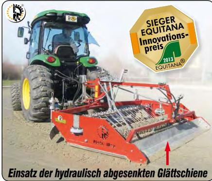
Der Platz-Max für die unterschiedliche Bearbeitung verschiedener Tretschichten
